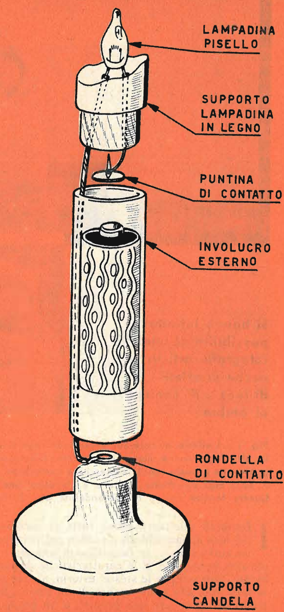
Fig. 1 - L'abilità nel costruire questa bugia elettrica consiste nel conferire al complesso la massima somiglianza con una candela di cera. Si noti a tale proposito la forma della parte superiore del supporto della lampadina che fa pensare alla consumazione della cera della candela.
