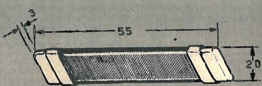
Fig. 3 - L'avvolgimento della bobina di sintonia è ottenuto su nucleo ferroxcube di forma rettangolare. Le dimensioni in millimetri, indicate in figura, sono di tipo standard.
