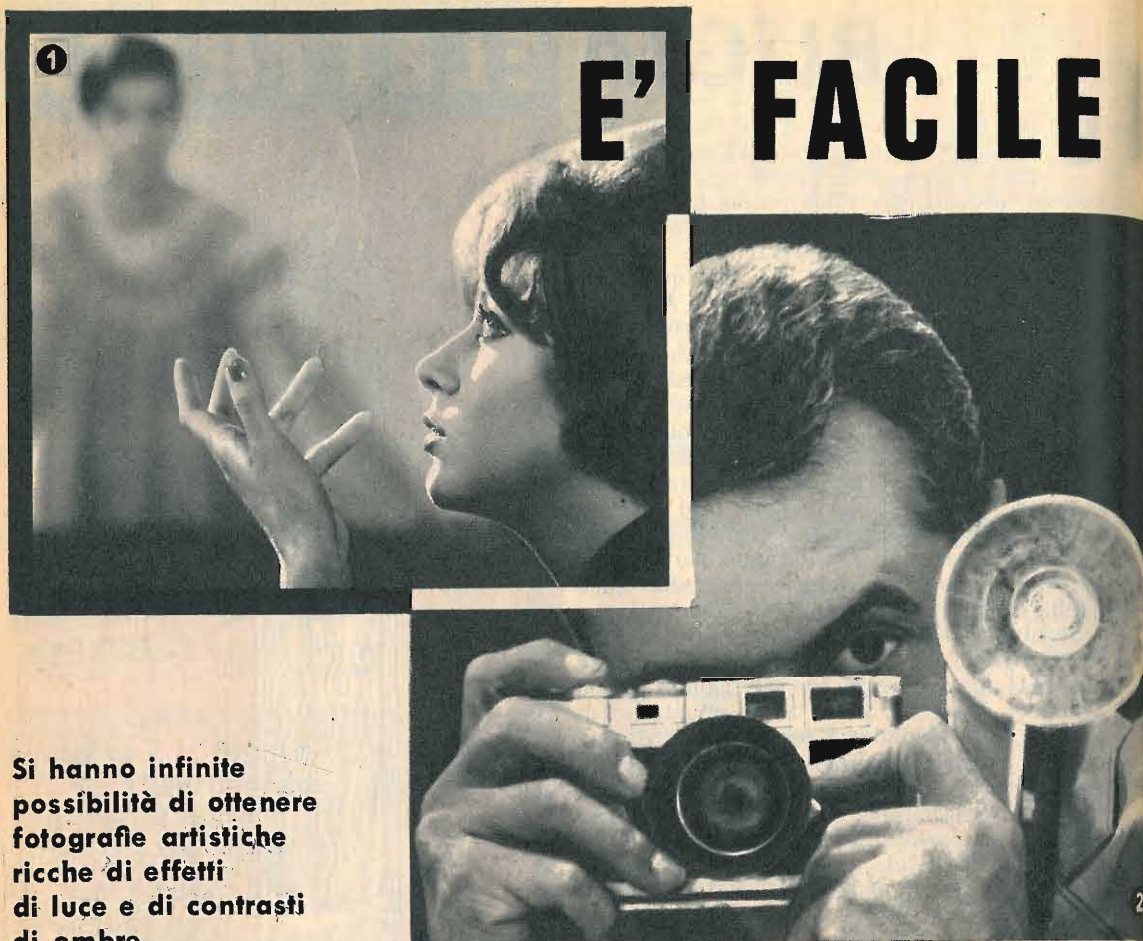
Fig. 1 - L'effetto di luce sul profilo del viso e sulle mani è dato direttamente dal lampo che si trova in alto leggermente dietro il soggetto. L'illuminazione delle ombre deriva da uno schermo di stagnola, che è posto sopra la macchina fotografica. (1/30 - diaframma 11 - lampada PF 5 - pellicola P 33). Fig. 2 - Molto comune è l'applicazione del lampo direttamente alla macchina fotografica. Questa tecnica non è raccomandabile per il ritratto.
